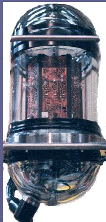
LED *beacon* para calibración temporal (LEDs azules).
