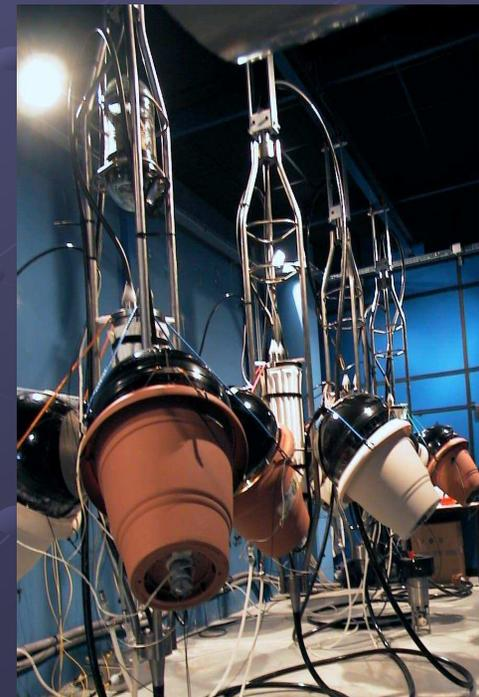
Los datos obtenidos sirven para medidas de la calibración relativa entre OMs y para calibración de la electrónica (ADCs).
