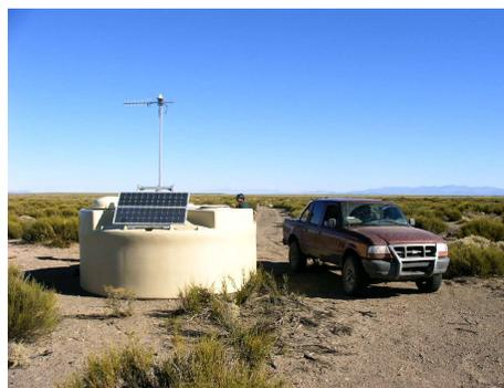
Figura 1. Fotografía de un tanque Čerenkov. En detalle los módulos fotovoltaicos.
