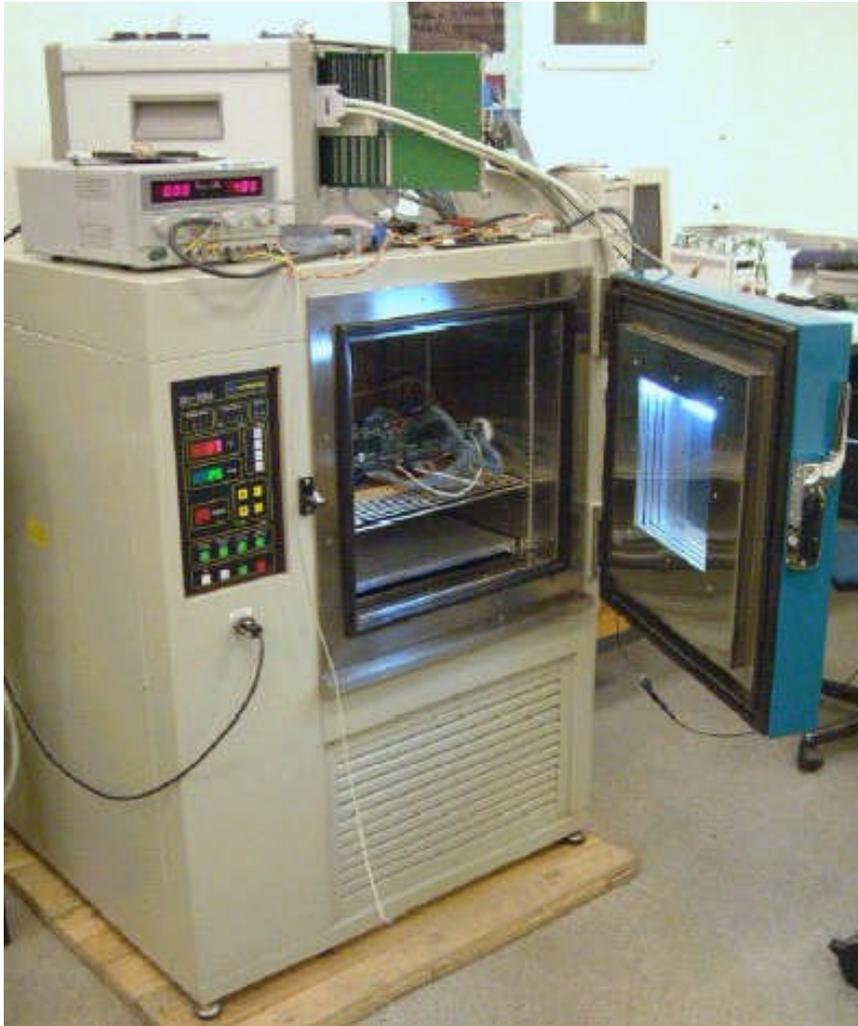
**Figura 7.20:** Imagen de la cámara climática utilizada para las pruebas de temperatura.
