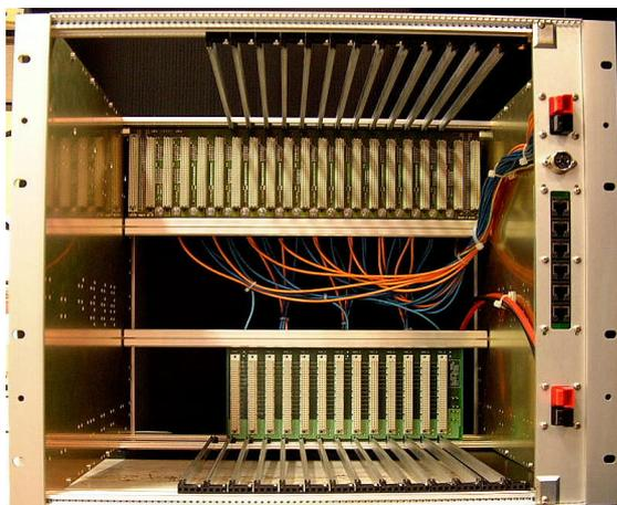
Figura 6.3: Imagen del chasis Sector Collector tras su fabricación.
