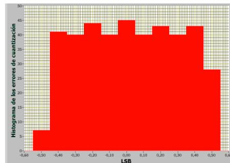
Figura 7.16: Distribución de los errores de cuantización del HPTDC.
