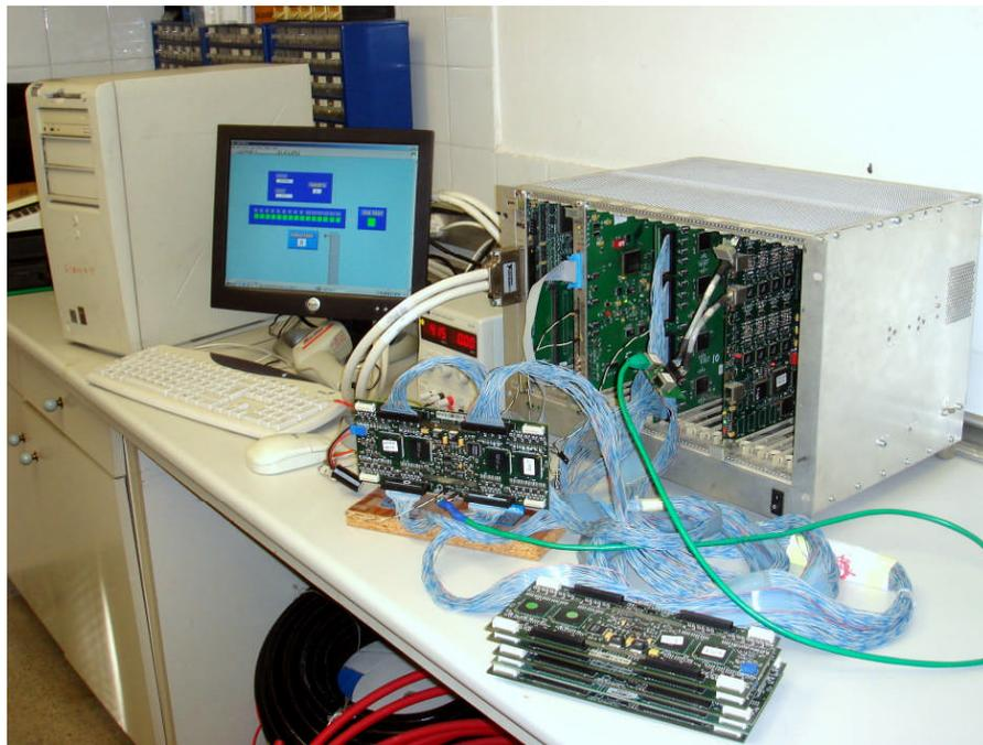
**Figura 3.40:** Sistema de pruebas de la tarjeta ROB.
