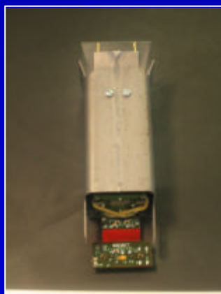
Celda unidad para la detección de luz Cerenkov. (El plano de detección del RICH contiene 680 celdas)
