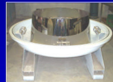
Molde para la fabricación del espejo del RICH
