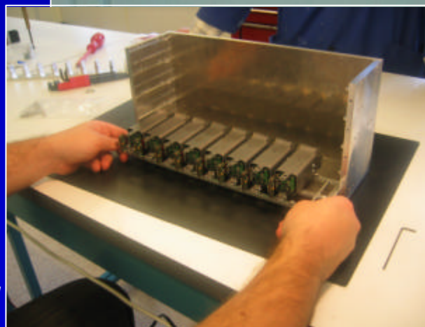
Prueba del ensamblaje del plano de detección del RICH
