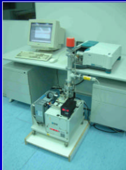
Medidas del envejecimiento óptico en vacío del AEROGEL de silicio
