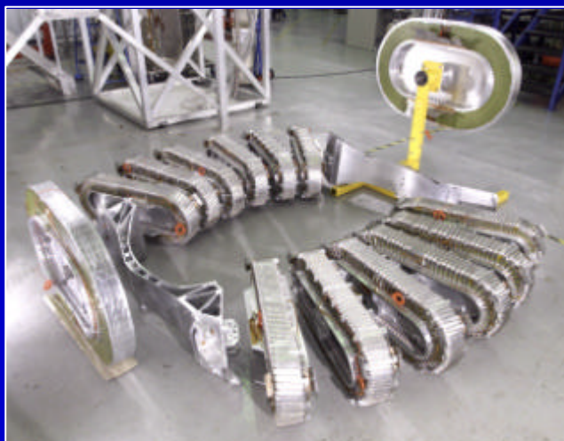
Bobinas superconductoras del Imán de AMS (Space Cryomagnetics Ltd. - Inglaterra)
