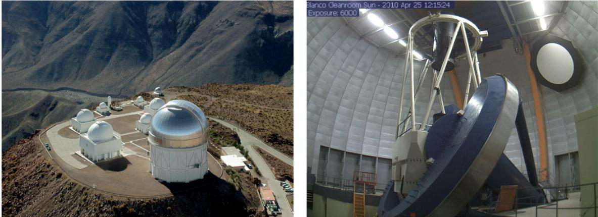
**Figura 5.8:** Vista del Observatorio de Cerro Tololo, Chile (izquierda). El telescopio Blanco (derecha) está situado en el edificio más grande. El cilindro negro en el foco primario se sustituirá por uno nuevo que contenga la cámara DECam (<http://www.darkenergysurvey.org/>).
